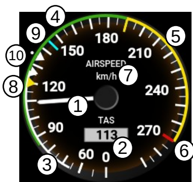
FIGURE 2.18 – Exemple d'indicateur de vitesse optimisé pour un avion utilisant des volets d'atterrissage à deux niveaux.
