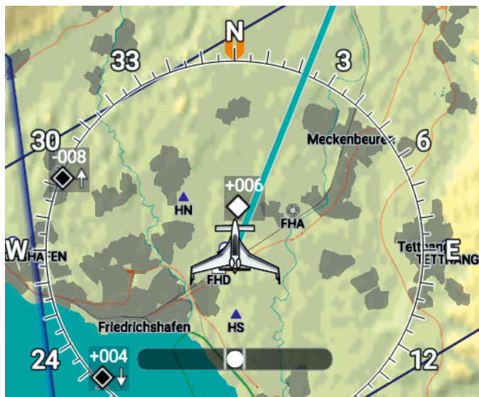
FIGURE 2.44 – Symboles de circulation sur une carte. La différence verticale se chiffre en centaines de pieds, car trois chiffres sont utilisés.
