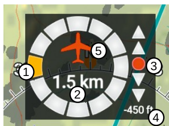
FIGURE 2.45 – La menace classée comme avertissement vient de la gauche, la distance est de 1,5 km, à peu près au même niveau visuel, 450 pieds en dessous.
