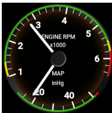
FIGURE 2.22 – La combinaison de l'indicateur de vitesse de rotation et de l'indicateur de pression du collecteur.
