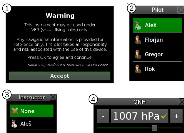
FIGURE 2.2 – Séquence de démarrage typique.
