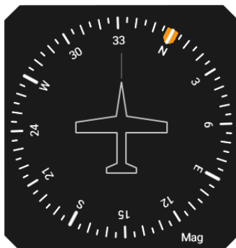
FIGURE 2.28 – Illustration de l'indicateur de direction.
