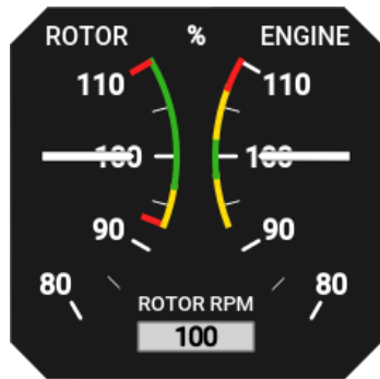
FIGURE 2.24 – Combinaison du régime du rotor et du régime du moteur. Les deux échelles sont en pourcentage.
