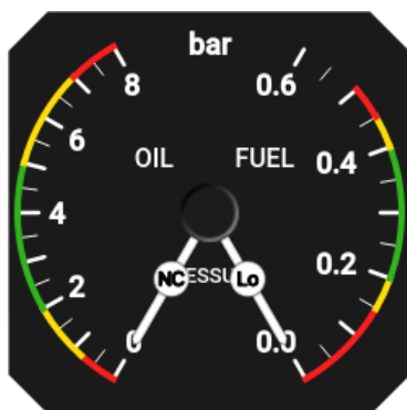
FIGURE 2.29 – Indicateur de pression rond, avec marquage spécial sur les aiguilles.
