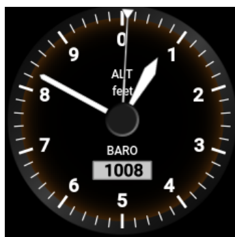
FIGURE 2.20 – L'indicateur d'altitude avec l'échelle donnée en pieds. Trois aiguilles sont représentées dans ce cas.
