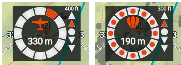
FIGURE 2.46 – À gauche : Alerte pour un l'avion, à 330 mètres, légèrement à partir de la droite, à 400 pieds au-dessus et à 10^{\circ} - 30^{\circ} au-dessus de l'horizon. À droite : Alerte pour un ballon, à 190 mètres, la direction n'est pas connue, 300 pieds au-dessus et 10^{\circ} - 30^{\circ} au-dessus de l'horizon.
