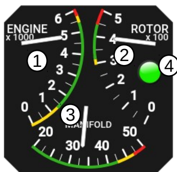
FIGURE 2.23 – Quatre en un : la combinaison du régime du moteur, du régime du rotor, de la pression du collecteur et du témoin d'aide au prélançement.
