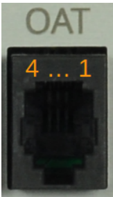
FIGURE 10 – Broches du connecteur OAT.
