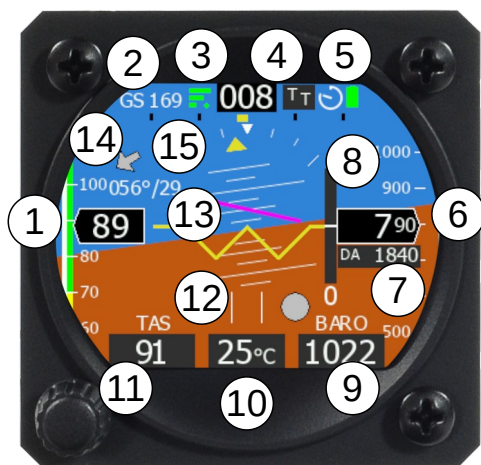
FIGURE 22 – Écran AD-AHRS de l'Horis avec marquages.
