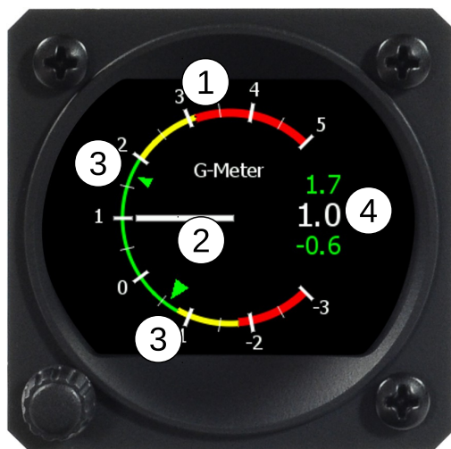
FIGURE 24 – Ajout de l'écran G-Mètre et de ses paramètres.
