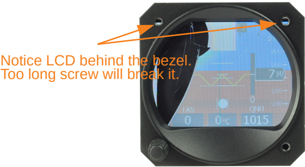
FIGURE 2 – Exemple d'écran LCD cassé. Le bord de l'écran LCD est visible derrière le cadre.
