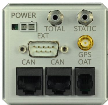
FIGURE 6 – Vue arrière de l'instrument avec les connexions. La vue est celle de l'Horis 57 mm.
